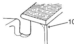
11. Das Treibglied dient zur Beseitigung von Sägestaub aus der Nut der Führungsschiene.
