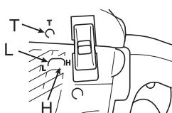
L: Regulador de mezcla de velocidad baja      H: Regulador de mezcla de velocidad alta
