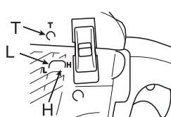
L: Justierung für untere Drehzahl      H: Justierung für obere Drehzahl
