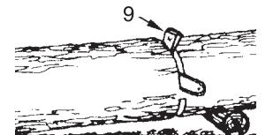
Realice un corte en ángulo, cuando una sección pueda apoyarse contra la otra.
