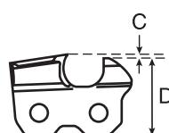
C: Calibro di profondità N1C-BL; 0,56 mm, 91PX, 91VG, 91VXL, 91VX, 90PX e 90SG; 0,65 mm
