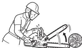
La funzione del freno catena consiste nell'arrestare la rotazione della catena dopo un contraccolpo.
