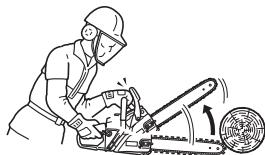
La función del freno de la cadena es detener la rotación de la cadena después de un retroceso.
