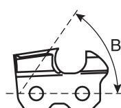
B: Angolo di taglio piastra superiore N1C-BL; 60°, 91PX, 91VG, 91VXL, 91VX, 90PX e 90SG; 55°
