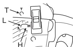
L: Vite di regolazione miscela bassa velocità      H: Vite di regolazione miscela alta velocità
